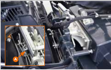
Elevador con acoplamiento rápido con palanca de seguridad (A) Elevador de engate rápido com alavanca de segurança (A)
